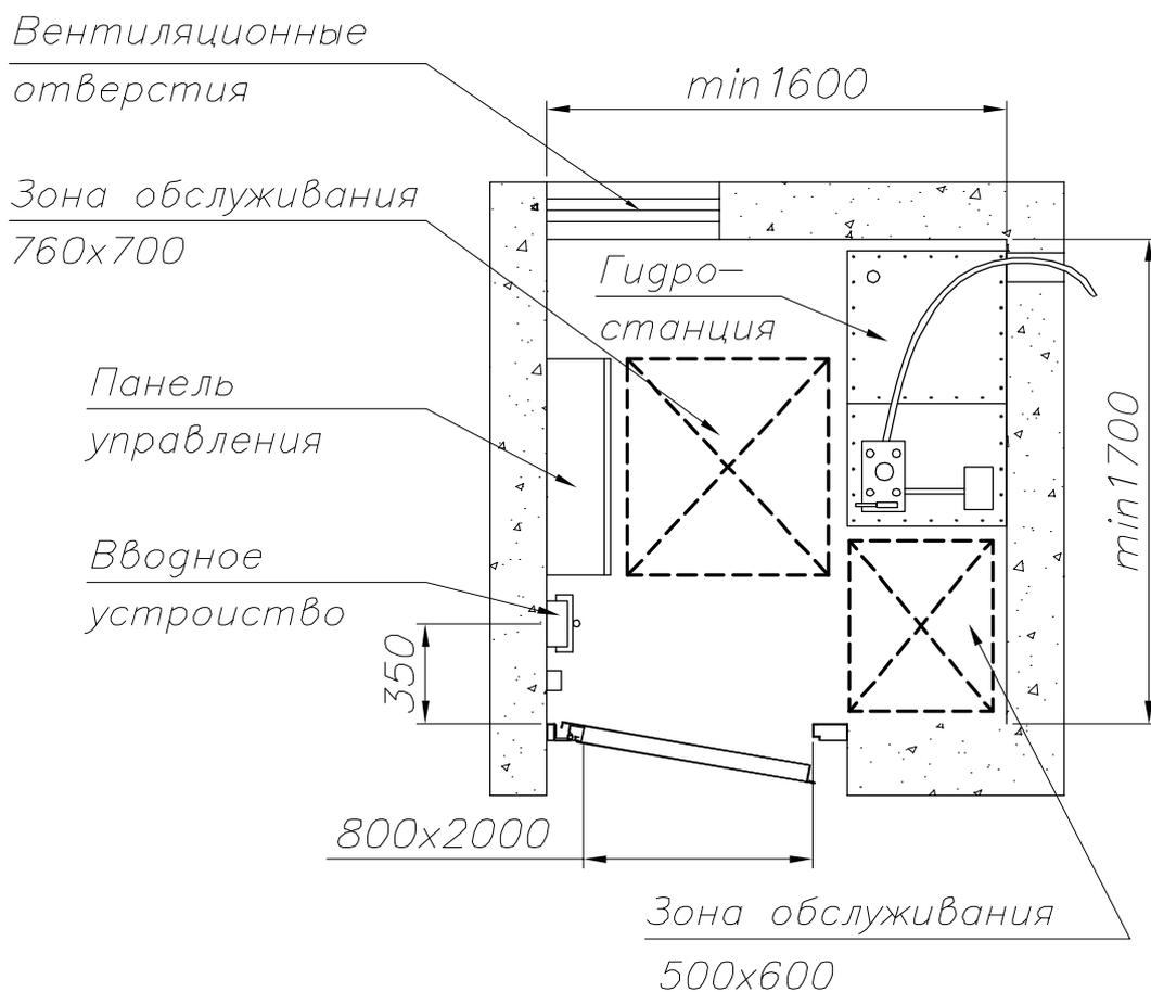
1. Отклонение ширины и глубины шахты от номинальных размеров должно быть в диапазоне от  $-20$  мм до  $+30$  мм.
